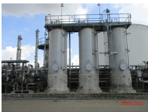
รูปที่ 8 Vapor Recovery Unit
