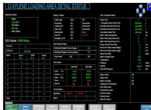
รูปที่ 7 หน้าจอควบคุมระบบไอสารไอโธคาร์บอนด้วยโปรแกรม PLC
